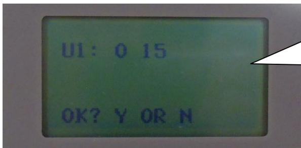
選択したユーザーボタンに核種データが登録されている場合、登録済データが表示されます。この様なユーザーキーに新しいデータを登録すると、古いデータ(左図の場合は 0-15)が削除されますので注意して下さい。
